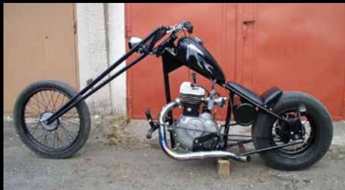
Fena, stavba motocyklu vlastní konstrukce, 1998 - 2002, motor FN 500 SV z roku 1930
