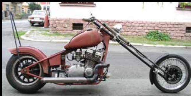
Prasopal, stavba motocyklu vlastní konstrukce, 2002 - 2003, motor Suzuki 1100 z roku 1985
