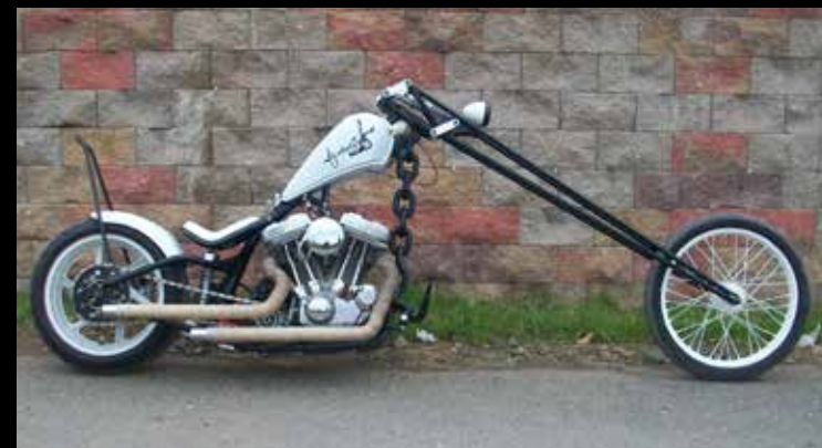
Alcoholica, rozdělaná stavba motocyklu vlastní konstrukce, 2010 - 2013, motor Harley Davidson 1100 z roku 1987
