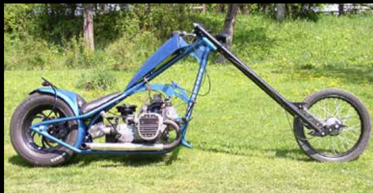
Blue shotgun, stavba motocyklu vlastní konstrukce, 2005 - 2007, motor Dněpr 750 z roku 1956
